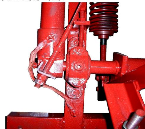
3.3. Проверить, положение поперечной трубы ТПБ.00–8 относительно страховочного крючка. Обеспечить зазор между поперечной трубой (при опускании токоприемника) и носком страховочного крючка 1...3 мм за счет перемещения поперечной трубы (см. ниже рис.).
