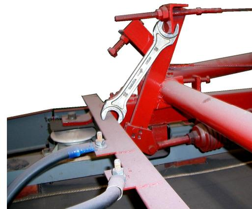
Дополнительно для ослабления подъемных канатов (тросов), соединенных с подъемными кривошипами, можно использовать доску. Зафиксировав упором кривошип, приподнять за вал каретки токоприемник до ослабления подъемных тяг и подложить доску под боковые трубы (Ø60 мм) токоприемника.
